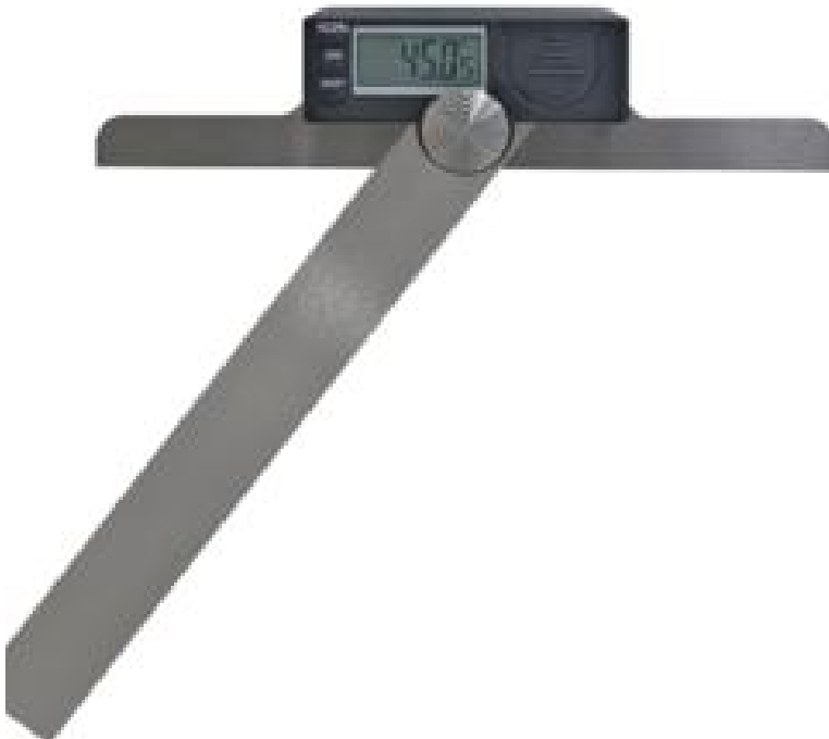
Abb. 11- 2: Winkelmesser zur Einstellung der Zweigelenkschwingen
