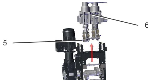
Abb. 7-3: Demontage der Querkraftachsen, Pumpeneinheit herausnehmen
