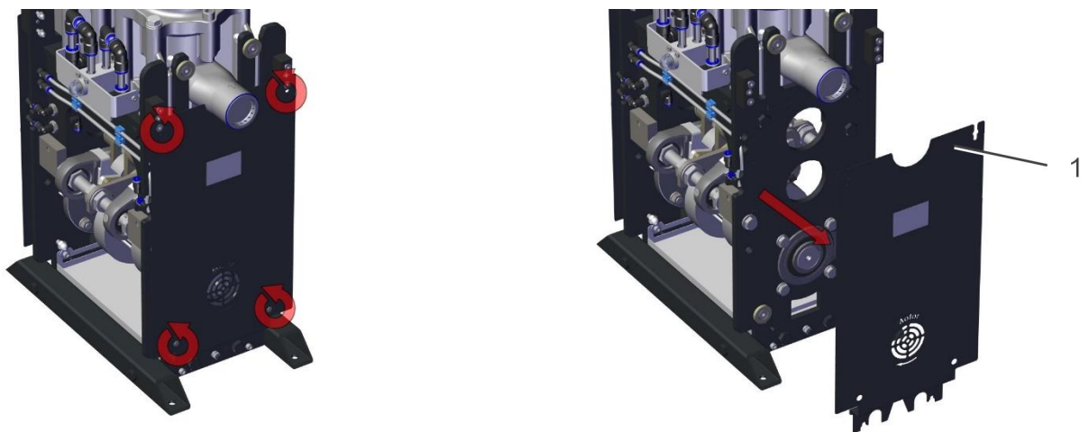
Abb. 4-7: Demontage der Anschlussverkleidung
